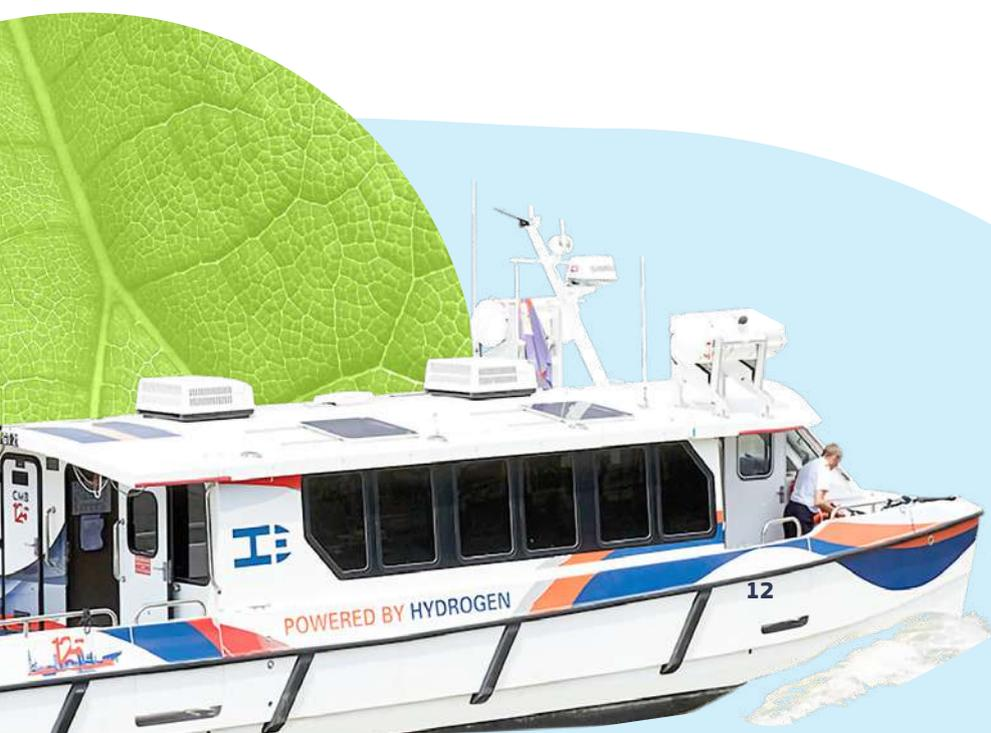
Hydroville est le premier navire à passagers certifié dont le moteur diesel fonctionne à l'hydrogène, Anvers, Belgique.
